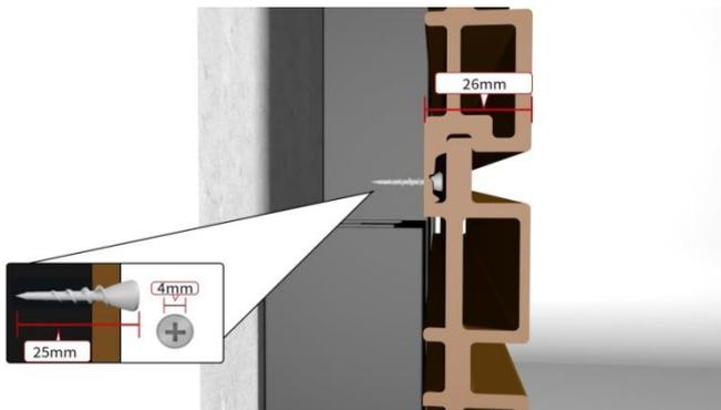
El tornillo se deberá fijar en la ranura de la hembra de las tablas (y contra el rastrel) y se ocultará con la pestaña o macho de la siguiente tabla. Una vez el primer panel haya sido fijado, el resto de las piezas pueden juntarse deslizando una sobre la otra.
